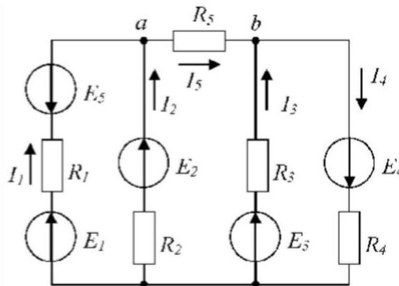
а)  $I_2 R_2 + I_3 R_3 + I_5 R_5 - E_2 + E_3$
