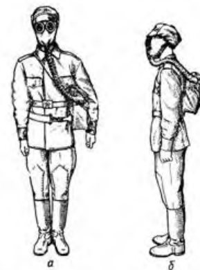
Аппарат ИП-4 (ИП-4М) в положении «боевом»: а - при расположении на боку; б - при расположении за спиной.
